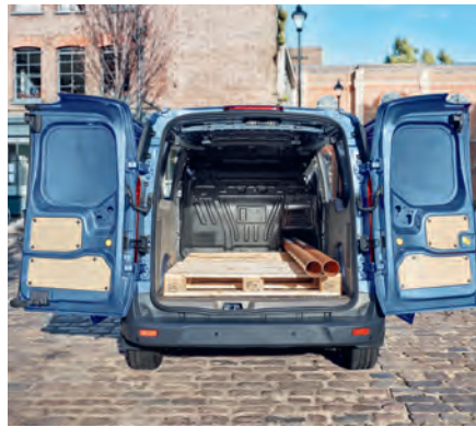
Zwischen die Radkästen passt eine Palette quer, macht Platz für zwei Ladungsträger im Frachtabteil.
