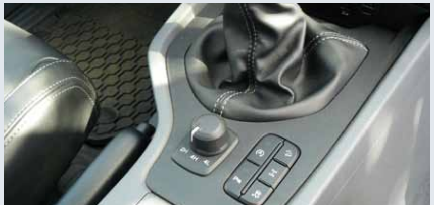
Der Allradantrieb lässt sich bei flotter Fahrt zuschalten, dann gibt's da noch die elektronische Hinterachssperre und eine sehr rigide Untersetzung.
