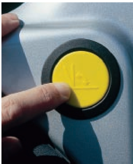
Ein Fingerdruck genügt: Saubere Entriegelung der Hecktüren für die Erweiterung von 90 auf 180 Grad.
