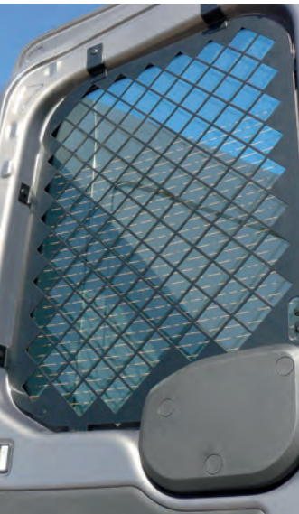
Ladung hinter Gittern: Mit Ladeboden, Wandverkleidung und Gittern in den Heckfenstern wird die Karosserie geschützt.
