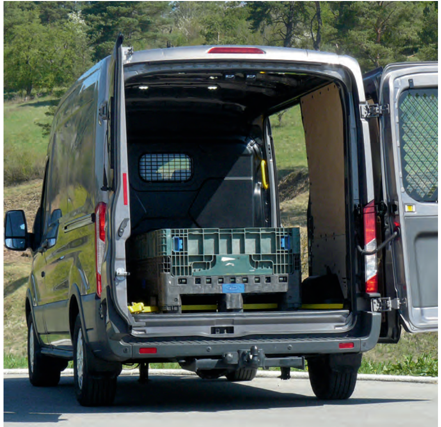
Mit Heck- und Allradantrieb hoher Boden, aber gut nutzbarer Laderaum, kräftige Zurrösen, LED-Strahler – jedoch ein rutschiger Einlegeboden ab Werk.
