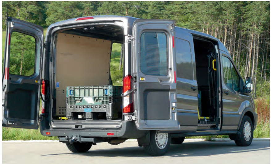
Die Heckflügeltüren vermeiden eine Kollision mit den großen Schiebetüren.
