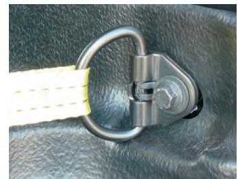
Die Zurrösen wirken solide und stabil, der Kunststoffboden ist rutschig.
