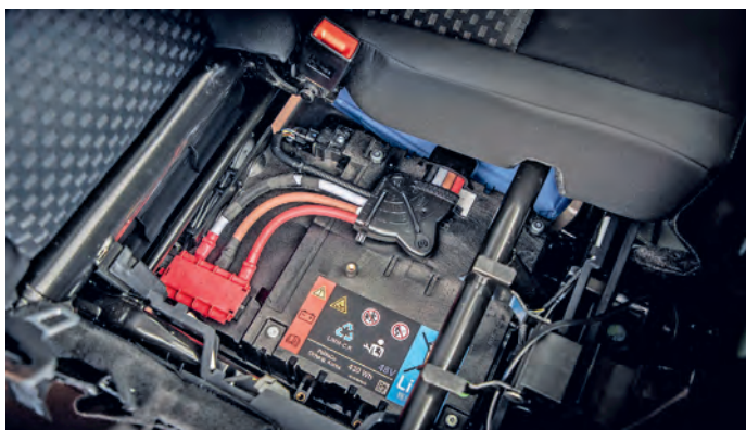
Beim Transit mit mildem Hybrid nimmt eine zusätzliche Batterie mit 48-Volt-Technik unter dem Beifahrersitz Platz.
