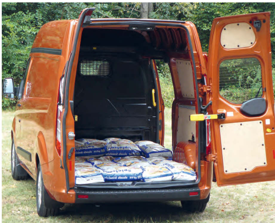
Die starre Hinterachse knickt auch unter voller Belastung nicht ein, der Ford zeigt Rückgrat.
