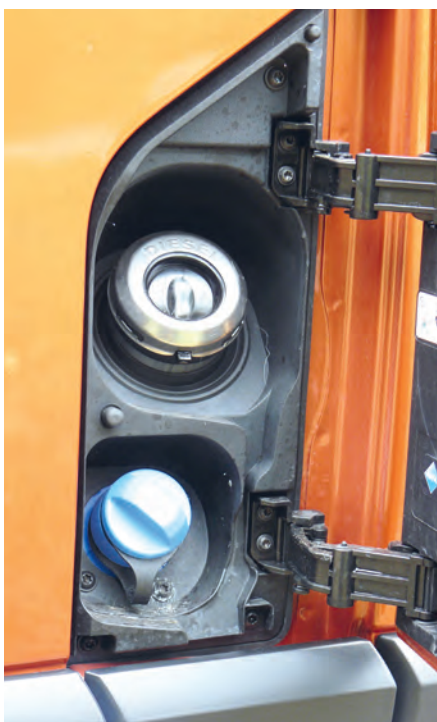
Einfüllöffnungen für Diesel und AdBlue hinter einer gemeinsamen Klappe, günstiger Verbrauch
