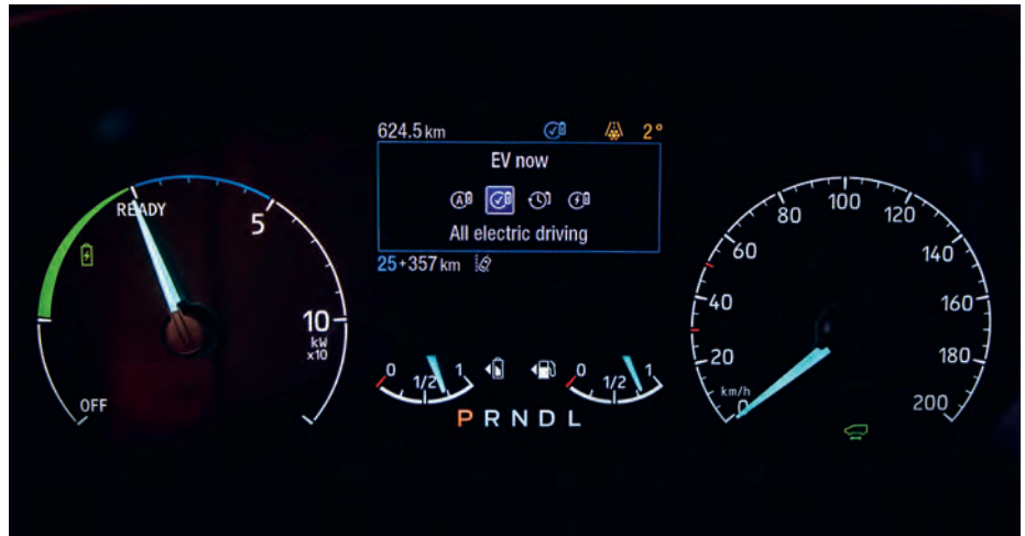
Volle Information: Powermeter statt Drehzahlmesser, vier Fahrmodi, Reichweite separat für Batteriebetrieb und Range Extender, zwei Füllstände für Batterie und Benzintank.
