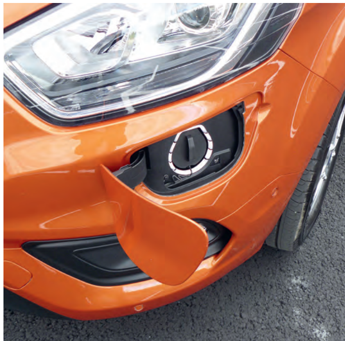
Plug in: Steckdose für die Aufladung per Kabel vorne links unter dem Scheinwerfer.
