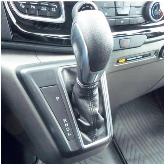
Fahrtrichtung und Rekuperation des Hybriden steuert der Fahrer über einen Wählhebel à la Automatikgetriebe.
