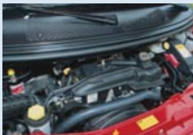
Der 2,4-l-Motor ist in der gewichtigen Transit-Baureihe längs eingebaut und treibt die Hinterräder an.
