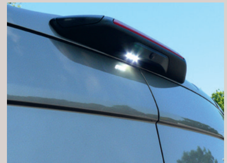
Es werde Licht: separat schaltbare LED-Arbeitsleuchte für Außenarbeiten.
