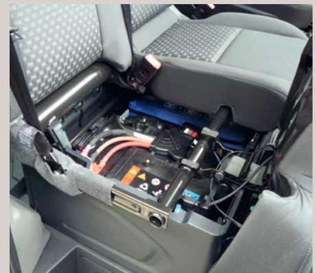
Rechts in der Doppelsitzbank hat die Lithium-Ionen-Batterie des Mild Hybrid Platz genommen.
