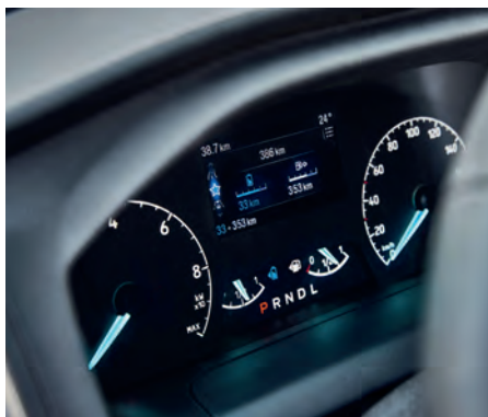
Zwei Reichweitenanzeigen, zwei Vorratsanzeigen für Kraftstoff – Kennzeichen für den Doppelherz-Transit Custom.
