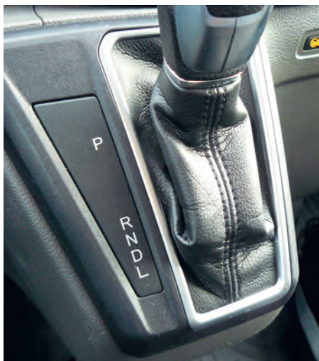
Wählhebel à la Automatikgetriebe, ergänzt durch die Position L mit höherer Rekuperationsleistung.
