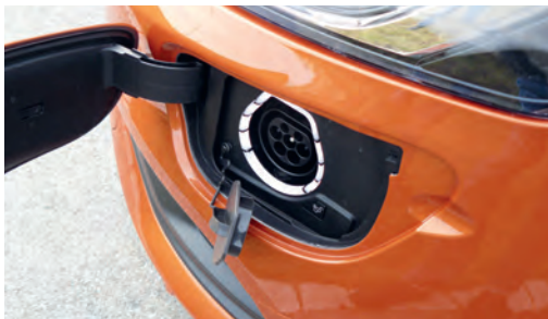
Der Ladestecker hat vorn links Platz genommen, schnelles Laden ist überflüssig angesichts der kompakten Batterie.
