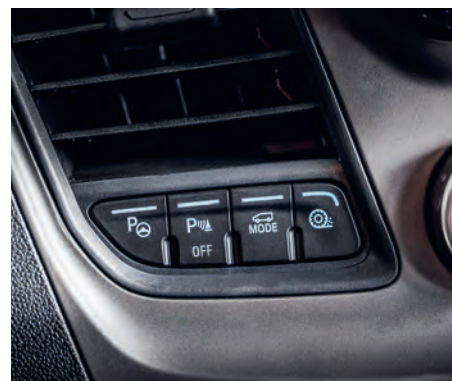
Mit der gut versteckten Mode-Taste wechselt der Fahrer bei Bedarf zwischen den Modi. In Zukunft klappt's automatisch per Geofencing.
