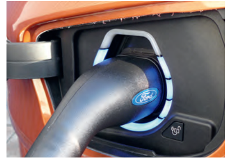
Strom tanken: Der Ford sollte möglichst oft an die Steckdose, pulsierender Ring für den Ladezustand.
