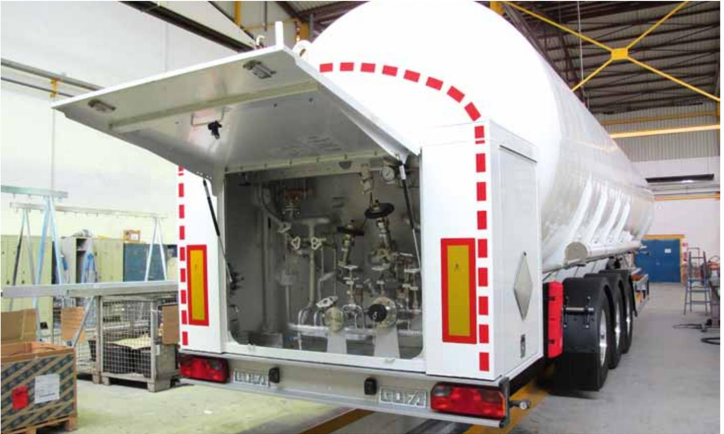
Keine einfache Trailertechnik: Gofa-LNG-Tankwagen
