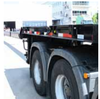
Nichts Besonderes bei Goldhofer: dreifach teleskopierbares Plateau
