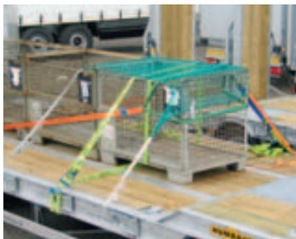
**Tandem-Dreiseitenkipper, zweiteilige Bordwände (oben links); Ganzstahl-Pritsche mit zweiteiligen Rampen (oben rechts); Vorsortierung: Verbindungsleitungen aufgeräumt (unten links); Ladungssicherung per Bucht- und Kopflasching**
