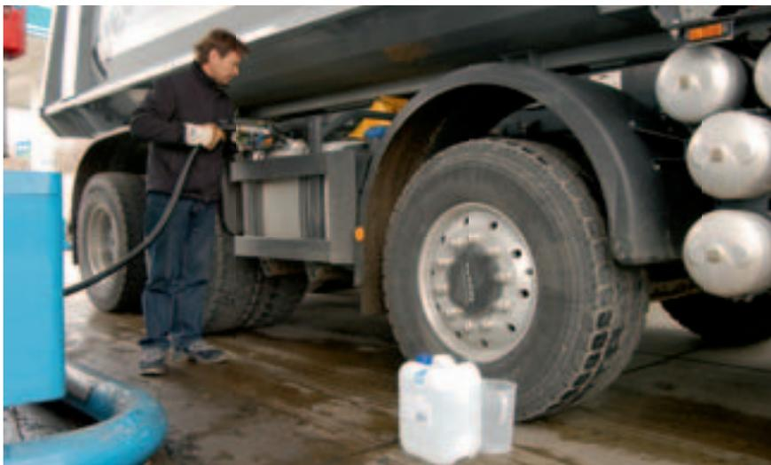
**Getankt wird Diesel plus Adblue – hier sind es etwa fünf Prozent des Kraftstoffverbrauchs.**
