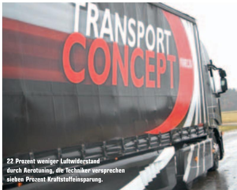
22 Prozent weniger Luftwiderstand durch Aerotuning, die Techniker versprechen sieben Prozent Kraftstoffeinsparung.
