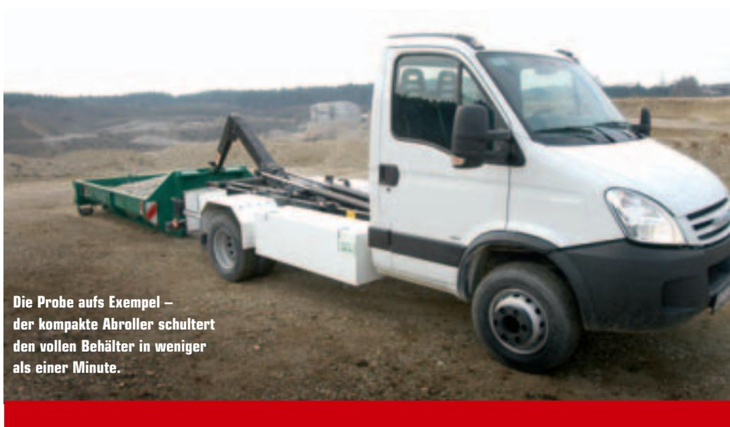
Die Probe aufs Exempel – der kompakte Abroller schultert den vollen Behälter in weniger als einer Minute.
