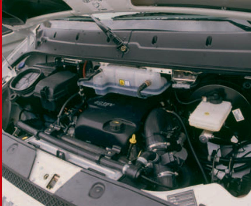
**oben:** Der Gasmotor stammt direkt vom Turbodiesel ab, umfangreich umgerüstet und im Werk eingebaut.
