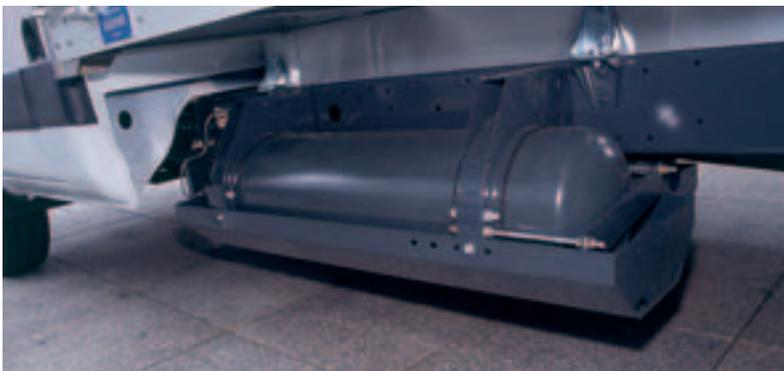
**links: Vorteil der Rahmenbauweise: Der Raum rund um die Längsträger bietet Platz für die Gastanks.**
