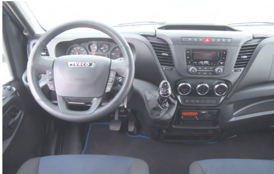
Der Fahrer Arbeitsplatz: nur in der Höhe verstellbares Lenkrad, intuitive Bedienung
