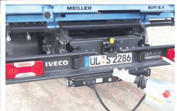
Gut gerüstet für den Zugbetrieb: Maul- und Hakenkupplung, die Wandlerautomatik schaltet ohne Zugkraftverluste.
