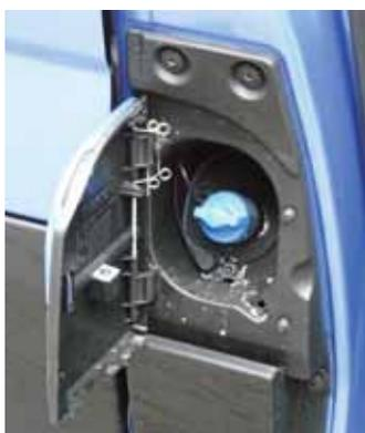
SCR-Technik gibt es für den großen Diesel serienmäßig, für den kleineren Motor auf Wunsch ab Januar. Einfüllstutzen rechts unten an der B-Säule, nicht immer kleckerfrei.
