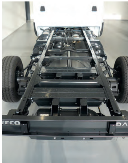
Der Daily als Tank-Wagen: Bis zu sechs Gastanks sichern eine Reichweite von mehreren hundert Kilometern.
