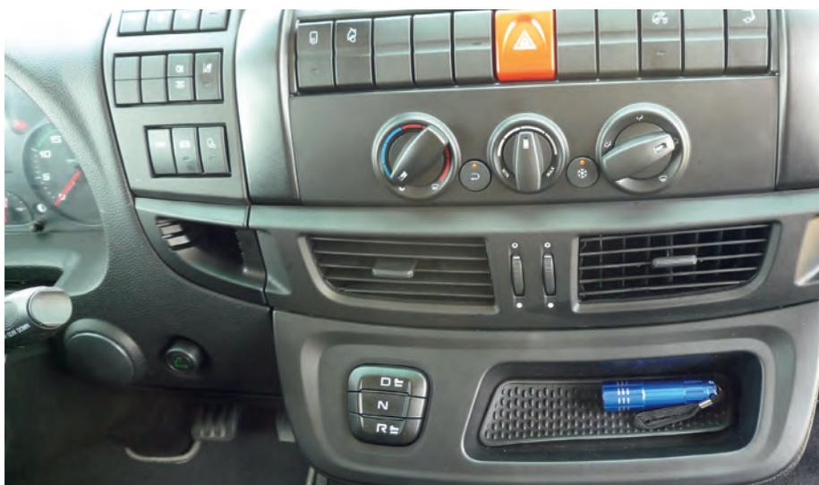
Kein Schalthebel verstellt den Weg: Das automatisierte Getriebe wird mit den DNR-Schaltern aktiviert.
