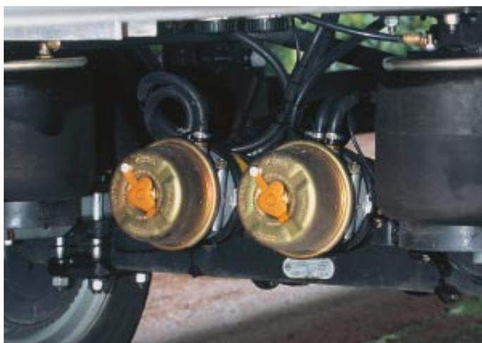
**Aufwändig gefedert:** Die BPW-Achse trägt fünf Tonnen und verfügt über eine Luftfederung sowie eine Druckluftbremse.
