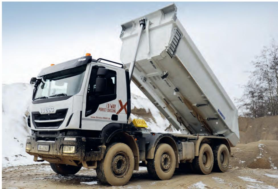
Noch besser ins Gelände passt der X-Way Hinterkipper mit Offroad-Paket, fehlendem Frontunterfahrerschutz und Bodenschutzblech.
