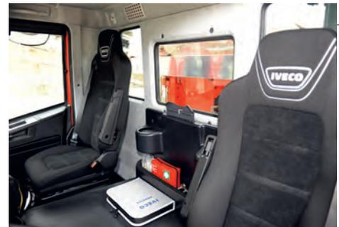
Der Stralis X-Way im Onroad-plus-Style mit Hypoidachsen ist mehr für den Straßeneinsatz getrimmt. Für den Blick auf die Ladung verpasst Iveco seinen X-Way 8x4 eine Dachreling samt seitlichem Tritt am Fahrerhaus (oben rechts). Hinter den beiden Sitzen ist nur Platz für dünne Jacken am Haken vorhanden. Eine Halterung an der Kabinenrückwand dient als zusätzliche Ablage.
