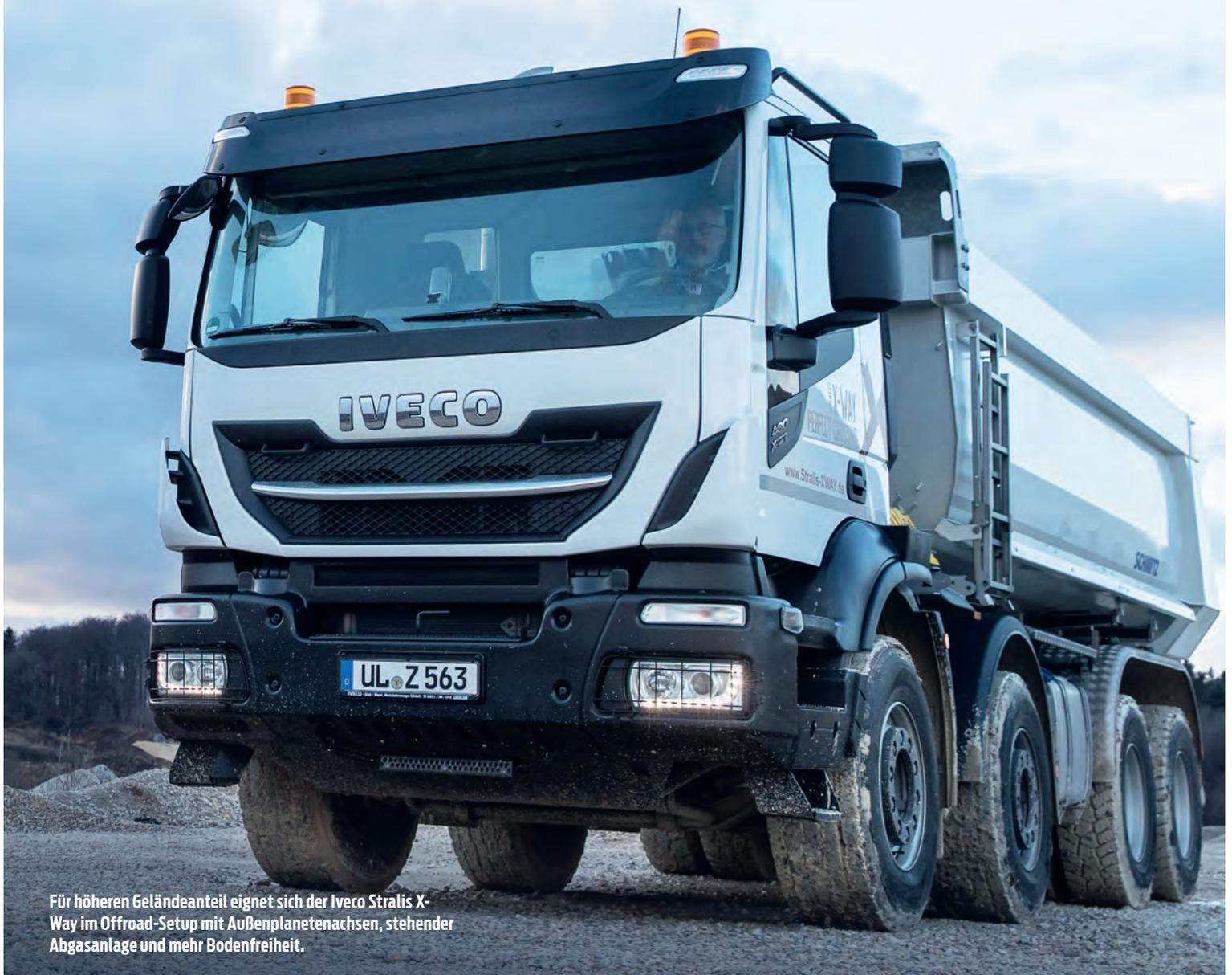
Für höheren Geländeanteil eignet sich der Iveco Stralis X-Way im Offroad-Setup mit Außenplanetennachsen, stehender Abgasanlage und mehr Bodenfreiheit.
