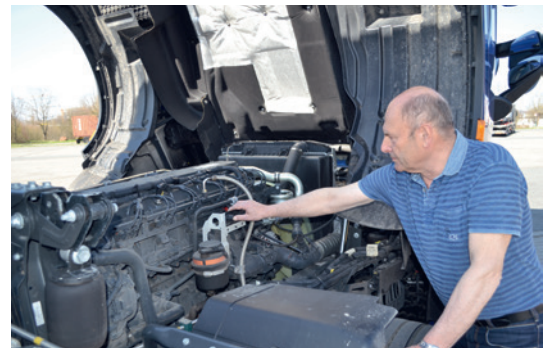
Blick auf das Erdgas-befeuerte Cursor-Triebwerk
