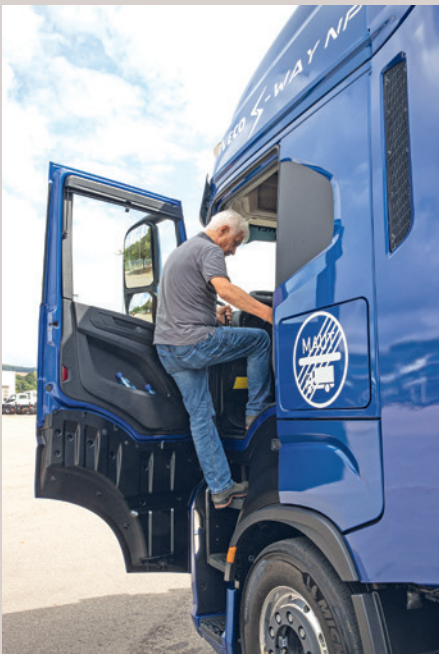
Eine Stufe mehr: weil das große Active-Space-Fahrerhaus nur einen minimalen Motortunnel besitzt.
