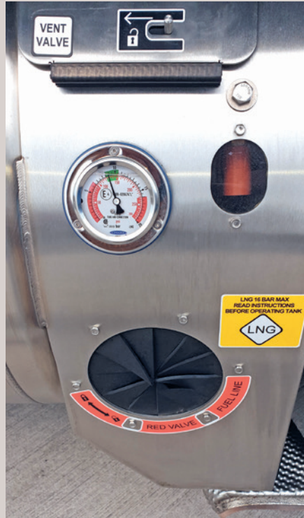
Nicht nur die Füllmenge macht's: Sinkt der Tankdruck bis in den roten Bereich, kann das LNG-Kraftstoffsystem den Gasmotor nicht mehr ausreichend versorgen.
