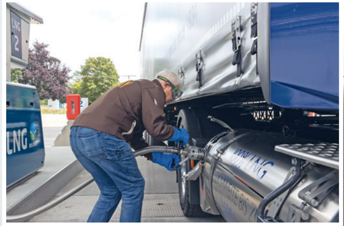
Kein Hexenwerk: Die Befüllung der tiefkalten Gastanks dauert nur wenige Minuten. Allerdings muss der Bediener Schutzkleidung tragen.
