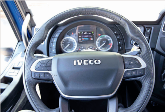
Feines Lederlenkrad mit Funktionstasten: Rechts die Tempomatbedienung, links die Tasten fürs Bordmenü und das Telefon.
