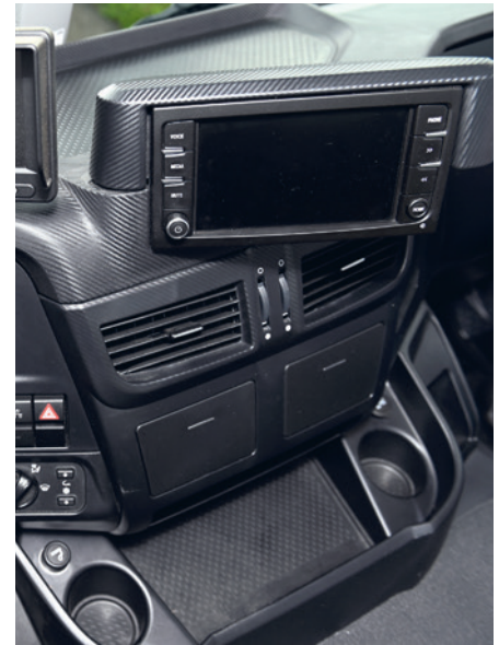
Der Fahrer bedient das automatisierte 16-Gang-Getriebe über die drei grauen Tastschalter.
