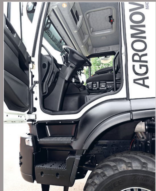
Von links: Rundum verbaute LED-Arbeitscheinwerfer sorgen für ausreichend Licht bei Nachtarbeit. Der nachgerüstete Anhängerböck am Heck erlaubt zusätzlich zum Sattel auch einen Anhängerbetrieb. Hochgesetzte Bauteile, viel Bodenfreiheit und massive Motorschutzplatten kennzeichnen die Iveco-Allradzugmaschine. Über drei Stufen vor der Lenkachse erklimmt der Fahrer das hoch aufgesetzte Trakker-Fahrerhaus.
