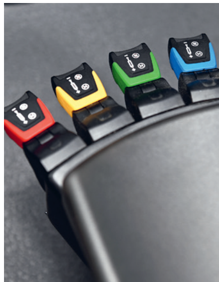
Über die Fingerprintsteuerung aktiviert der Fahrer die vier doppeltwirkenden Hydraulikkreisläufe.
