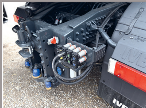
Von links: Rundum verbaute LED-Arbeitscheinwerfer sorgen für ausreichend Licht bei Nachtarbeit. Der nachgerüstete Anhängerböck am Heck erlaubt zusätzlich zum Sattel auch einen Anhängerbetrieb. Hochgesetzte Bauteile, viel Bodenfreiheit und massive Motorschutzplatten kennzeichnen die Iveco-Allradzugmaschine. Über drei Stufen vor der Lenkachse erklimmt der Fahrer das hoch aufgesetzte Trakker-Fahrerhaus.
