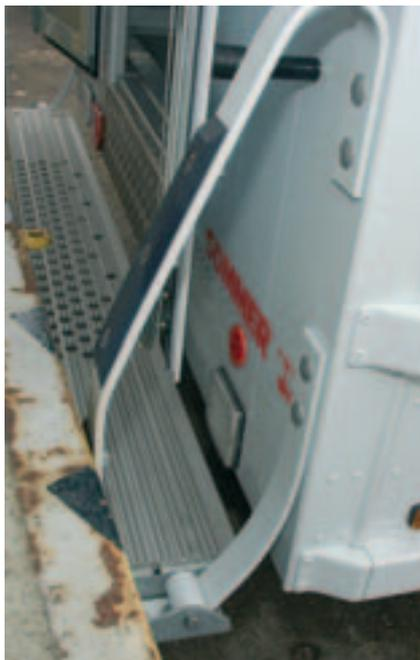
**Die Federbügel am Heck des Fahrzeugs – schützen die Aluminium-Trittplatte und den gesamten Aufbau vor kostspieligen Schäden.**
