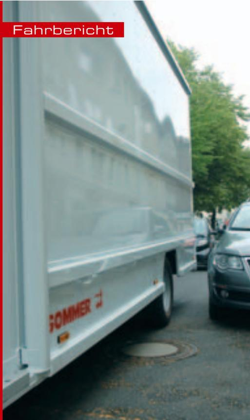
**Ganz deutlich zu erkennen: Die Profile am Außenrahmen schützen den leichten Aluminium-Aufbau bei möglicher „Feindberührung“.**
