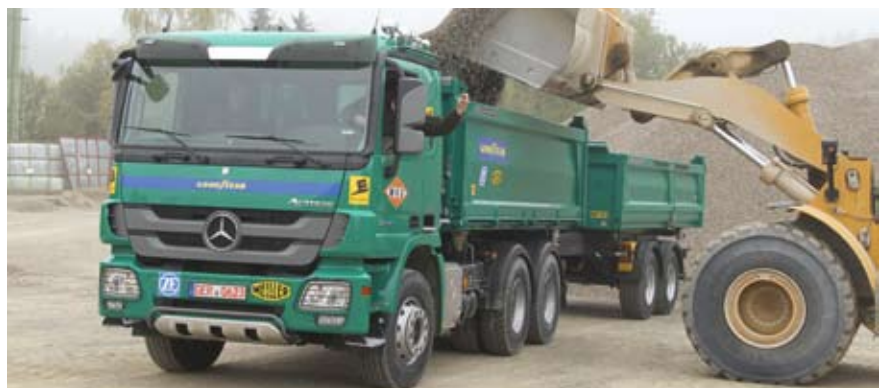
Exaktes Laden: Der MKU-Laderfahrer füllt die Mulden mit Hilfe einer hydraulischen Schaufelwaage.
