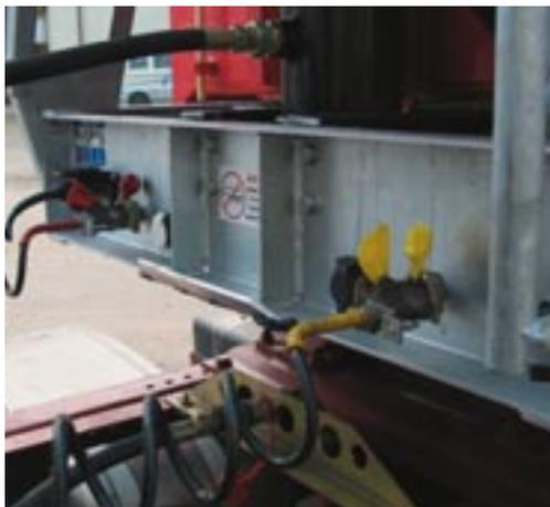
ABS-Kabel und Bremsleitung über Kreuz
