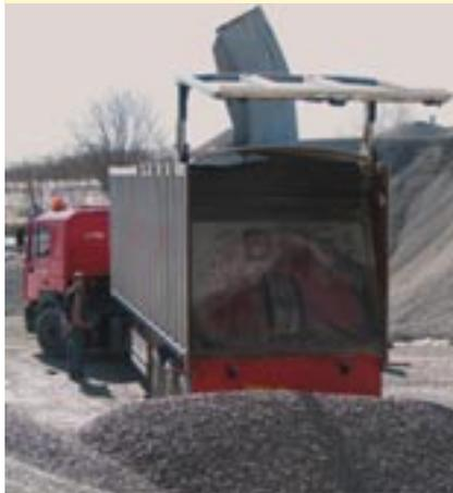
Abgeschoben: Fliegl Schubschild-Boden nach der Entladung
