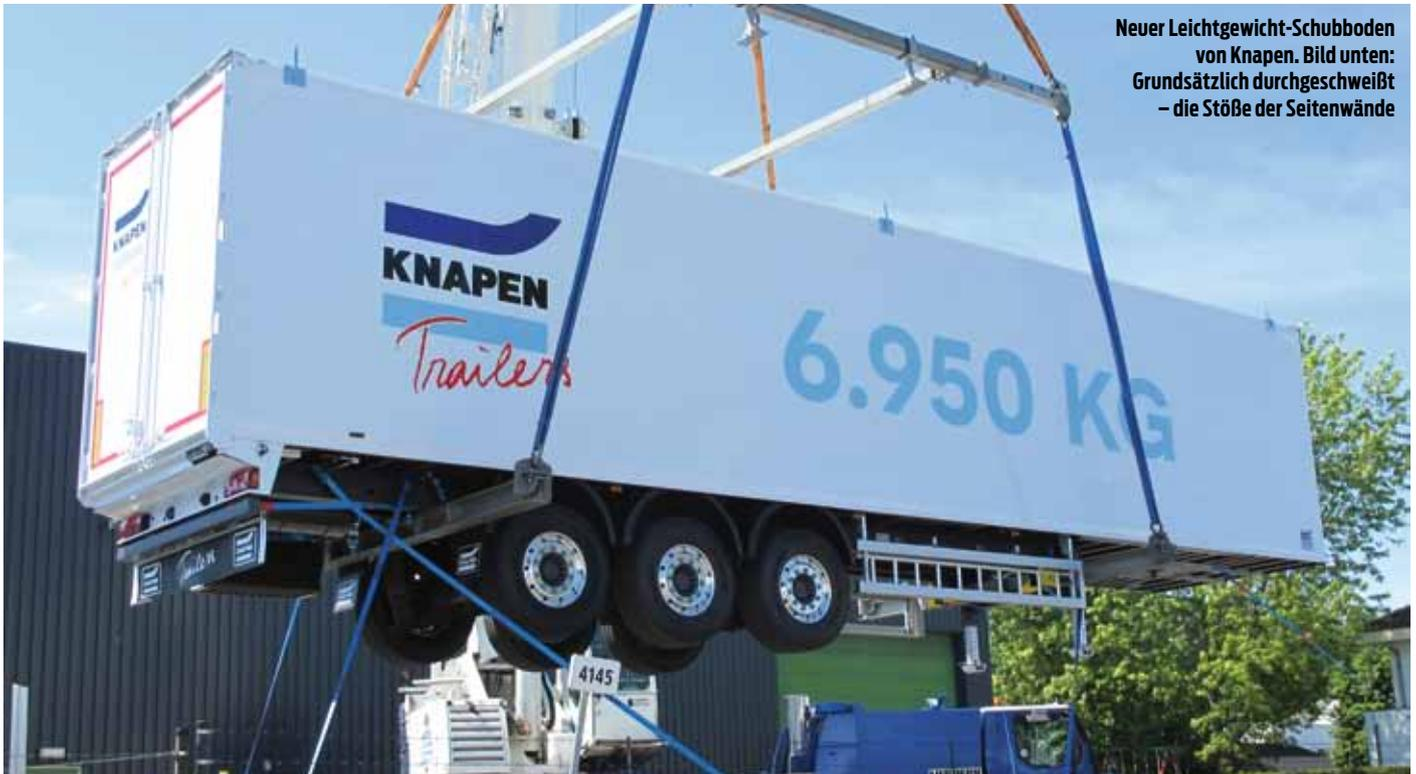
Neuer Leichtgewicht-Schubboden von Knapen. Bild unten: Grundsätzlich durchgeschweißt – die Stöße der Seitenwände
