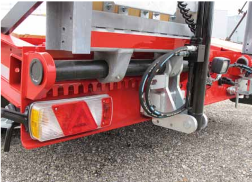
Rampenlagerung mit Hydraulikstempel
