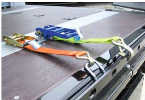
**Mehr Möglichkeiten: Zurring und Palettenstoßkante/Einhakleiste**
