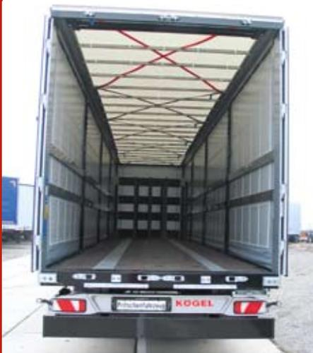
Längsträger durchlaufend, Böden parallel
