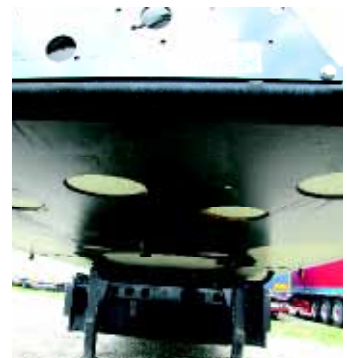
Aufsattelplatte mit integriertem Königszapfen
