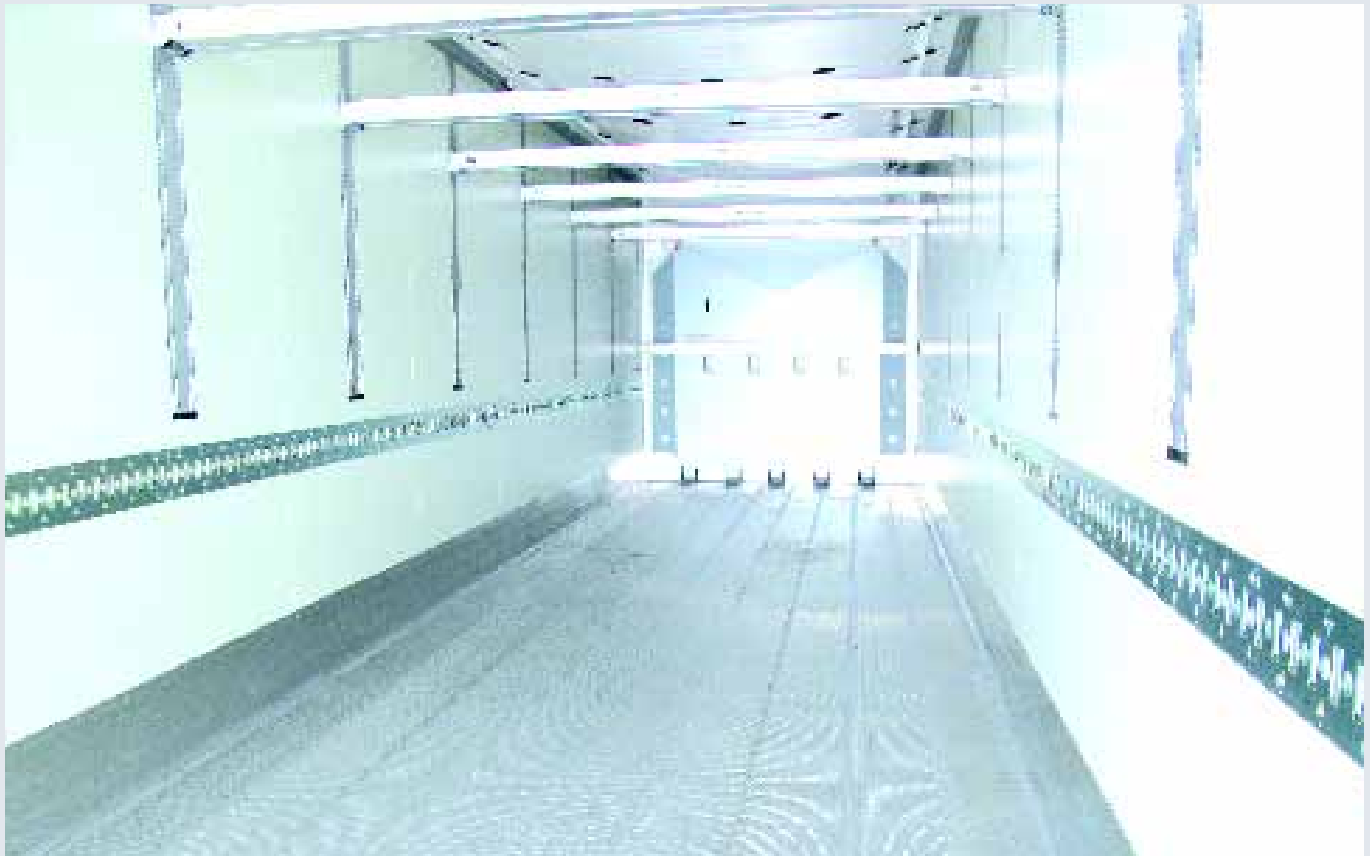
Innenausrüstung mit Load-Lok-Doppelstockschienen. Bild unten: Vierfach-Lamellen als Türdichtung
