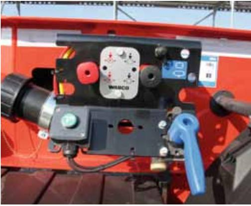
Armaturen für Bremse und Luftfederung
