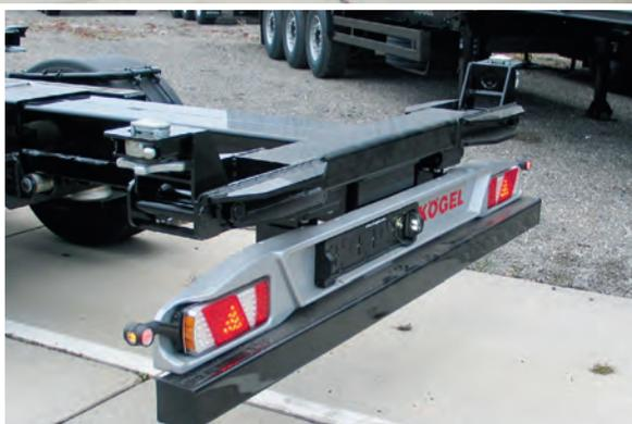
Hecktraverse mit waagerechten Rampenpuffern
