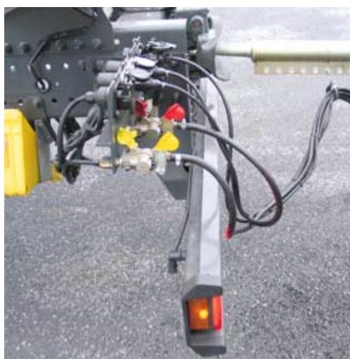
Für Stückzahlen: Krones Drehschemel-Wechselanhänger. Rechts unten: Werkzeug gefragt – Längszentrierer. Links unten: Praktisch – Rohrdeichsel und verstellbare Versorgungsleitungen
