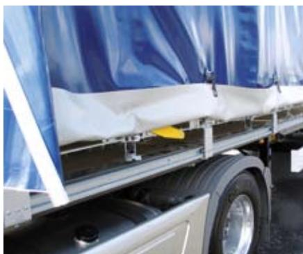
**Gegenhalter der Hecktüren klappbar, Seitenverzerrung mit Klemmschlössern (Bild oben links) Laufwagenverriegelung ausgehängen Lamellenführung hochklappen Zusammenfahren (Bild oben rechts) Plane hochfalten**
