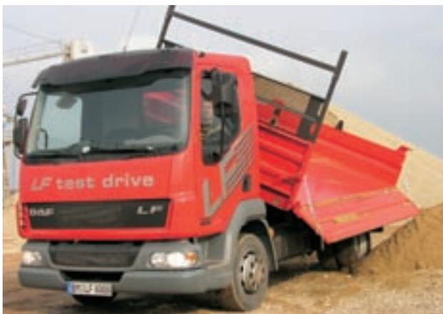
2,13 m breite Kabine erlaubt einen verrenkungsfreien Überstieg vom Fahrerplatz zur Beifahrertür und umgekehrt – dank 1,61 m Stehhöhe und ausreichend Freiraum vor den Sitzen.
