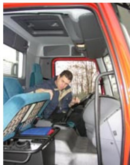
**Einstufiger Einstieg und niedriger Fußboden sowie ein weiter Türöffnungswinkel ermöglichen einen bequemen Einstieg. Das Kabineninterieur überzeugt durch einen zeitgemäßen Arbeitsplatz sowie hochwertige Materialwahl und Verarbeitung. Staufächer unter der Beifahrerbank und der Werkzeugkasten außen sind weitere praktische Details.**
