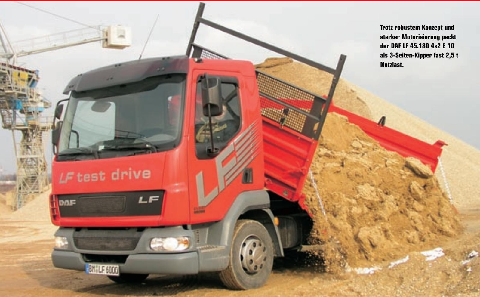
Trotz robustem Konzept und starker Motorisierung packt der DAF LF 45.180 4x2 E 10 als 3-Seiten-Kipper fast 2,5 t Nutzlast.
