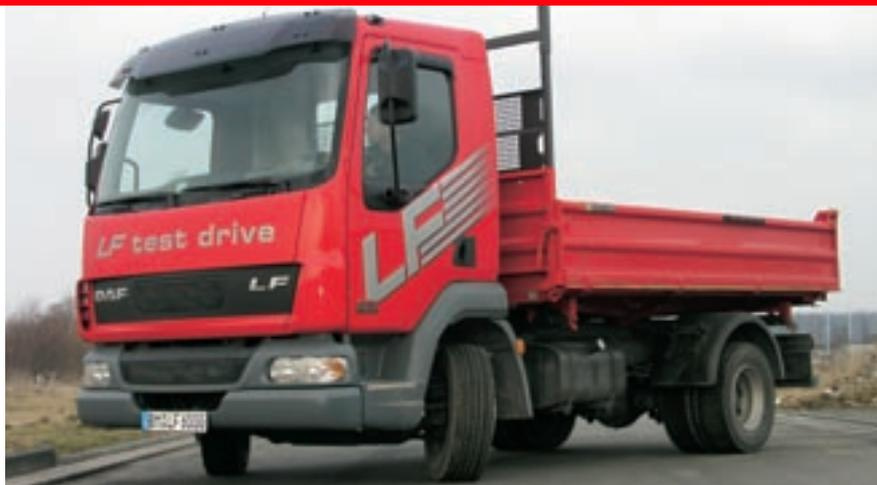
**Kurzer Radstand und ein Lenk-Einschlagwinkel von etwa 52° verleihen dem kompakten DAF-Kipper eine hohe Wendigkeit.**
