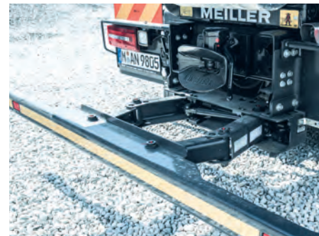
Hydraulisch betätigt: Scherenkonzept für den Unterfahrschutz. Hydrodrive-Antrieb für die Vorderachse: An der Nabenform kann man ihn erkennen.
