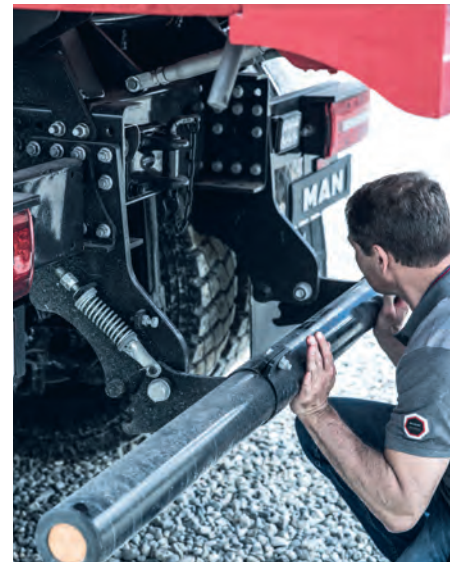
Ein leidiges Thema: Selbst mit Federkraftunterstützung muss der Fahrer fürs Aufklappen viel Kraft einsetzen.
