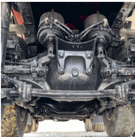
Trommelbremsen für die AP-Achsen: Keine veraltete Technik, die Bremszylinder werden elektronisch angesteuert.
