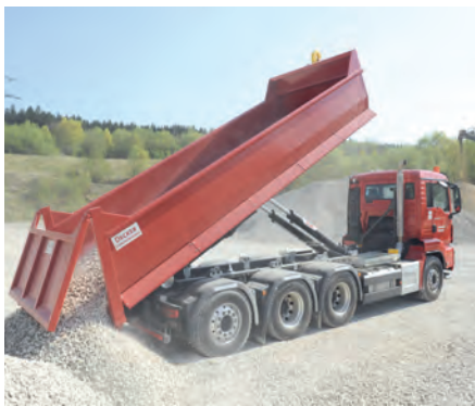
Vierachser mal anders: Die Tridem-Lösung empfiehlt sich für schwere Abrollkipper, hier ein TGS 35.500 8x4-4 BL mit luftgefedertem Hypoid-Antriebstandem und Hyva-Abrollsystem.
