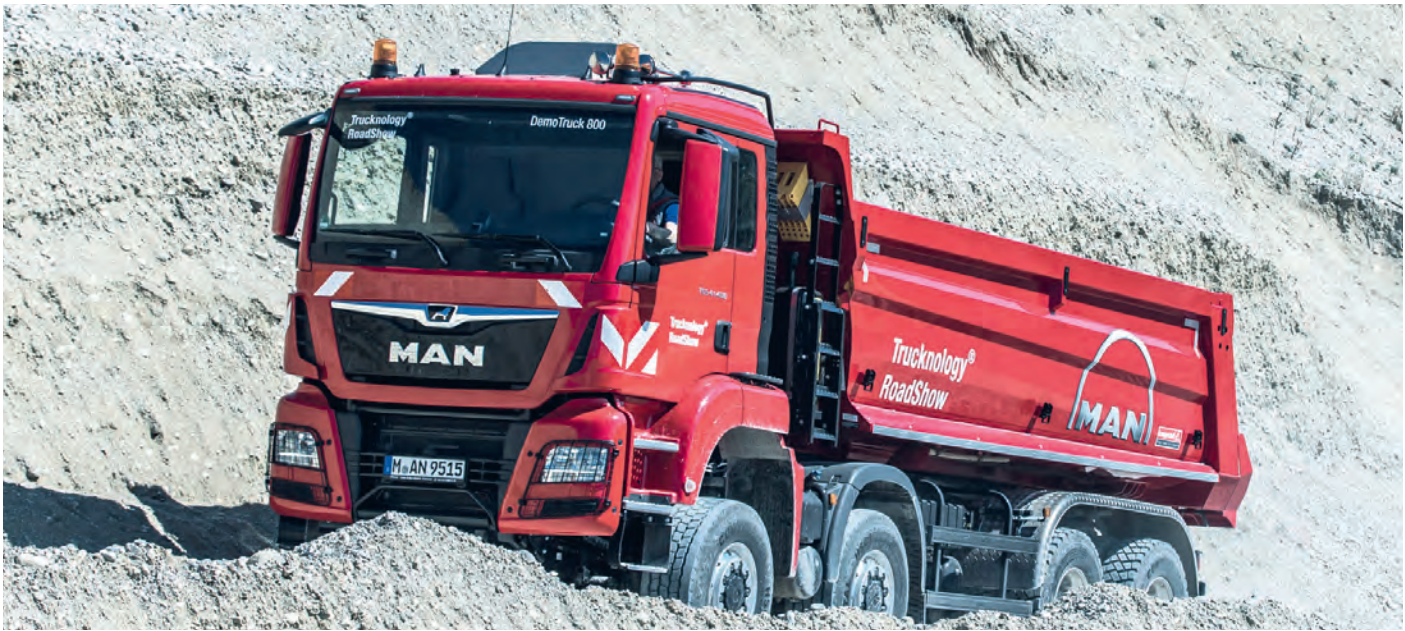
Traktion satt: Mit vier angetriebenen Achsen kennt der hohe TGS keine Limits, aber es kommt auch auf die richtige Reifenwahl an.
