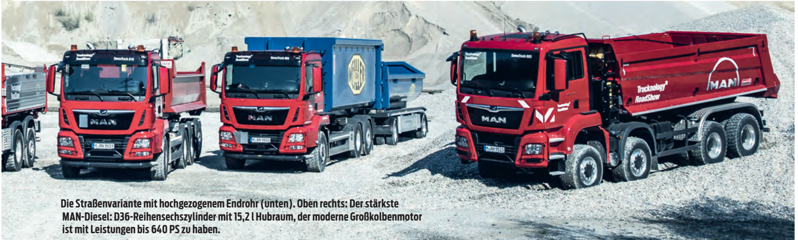
Ungemein traktionsstark im Gelände: der TGM-Allradler als Krankkipper und der souveräne TGS mit vier angetriebenen Achsen.
