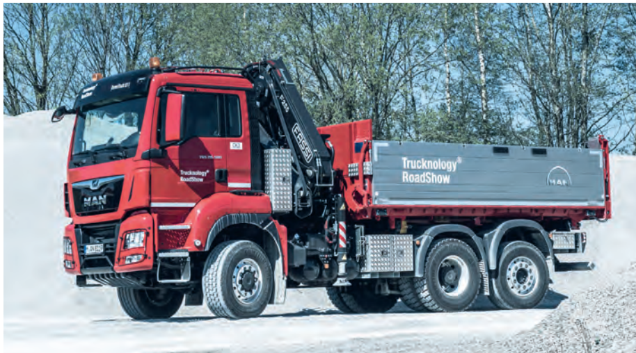
Vielseitig einsetzbar: Mit permanent angetriebener Vorderachse geht der schwere Krankipper durch dick und dünn. Mit der lenkbaren Nachlaufachse ist er wendig wie nur wenige.
