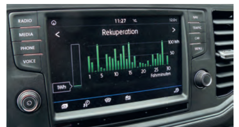
Powermeter statt Drehzahlmesser, der angezeigte Verbrauch ist realistisch, kann auch noch höher ausfallen. Im Stadtverkehr können aufmerksame Fahrer eifrig rekuperieren und somit Strom zurückgewinnen, die Reichweite wächst.
