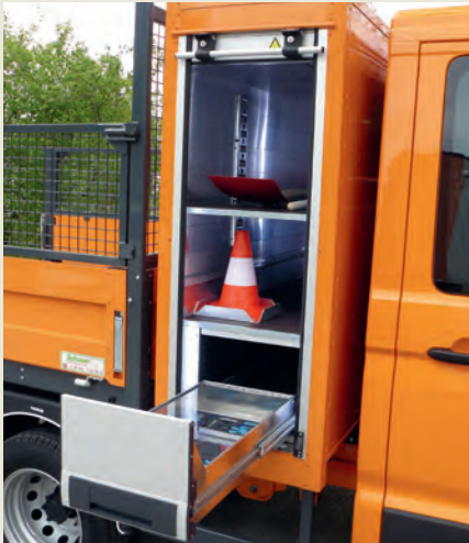
Aufgeräumter und beleuchteter Kasten für Werkzeuge und Gerät zwischen Fahrerhaus und Aufbau
