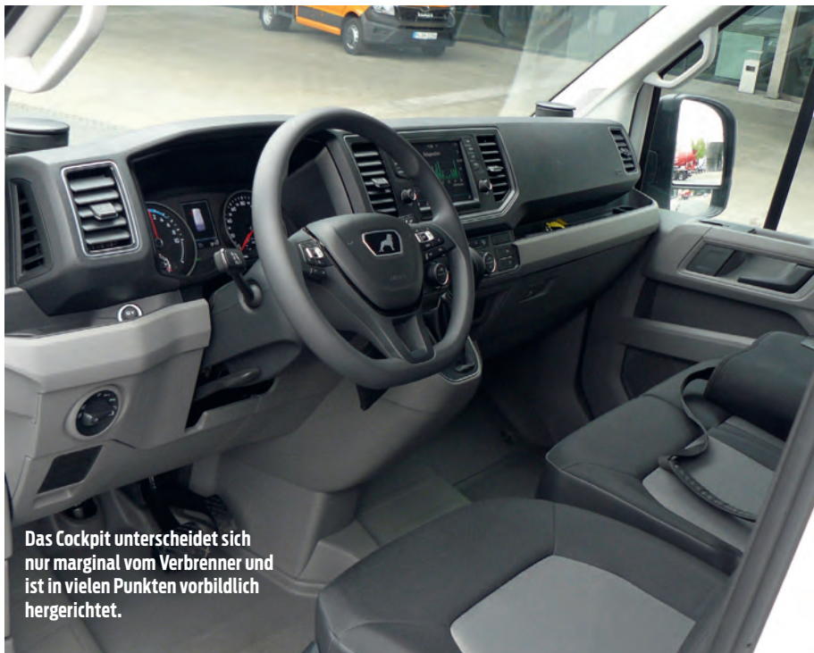
Powermeter statt Drehzahlmesser, der angezeigte Verbrauch ist realistisch, kann auch noch höher ausfallen. Im Stadtverkehr können aufmerksame Fahrer eifrig rekuperieren und somit Strom zurückgewinnen, die Reichweite wächst.
