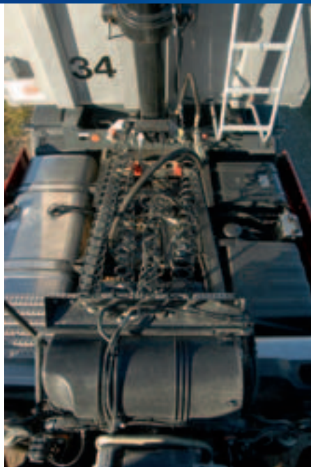
Rechts (in Fahrtrichtung) der große Alutank mit 780 Liter Kraftstoff, links der Hydrauliktank für den Kippauflieger. Ein Arbeitsplatz für Vorarbeiter – einfache Bedienung, hochwertige Anmutung.
