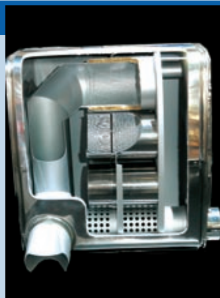
Bei MAN ist der PM-Kat im Auspufftopf integriert.
