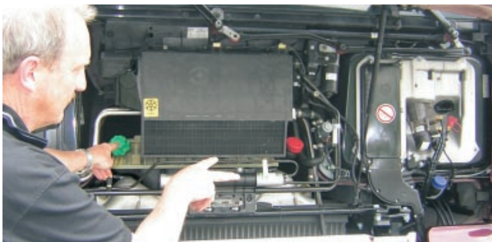
Die Nachfüllpunkte für Kühlflüssigkeit, Motorenöl und Scheibenwaschwasser sind hinter dem Frontgrill zusammengefasst.
