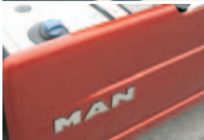
**MAN hat drei Funktionen (Auftritt hinterm Fahrerhaus, Diesel- und Ad-Blue-Behälter) in den Tankkörper integriert.**
