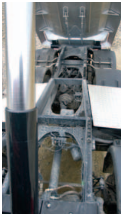
Mittelhoher Leiterraum aus U-Profil-Längsträgern, Querträgern, K-Verband und Rahmeneinlagen.
