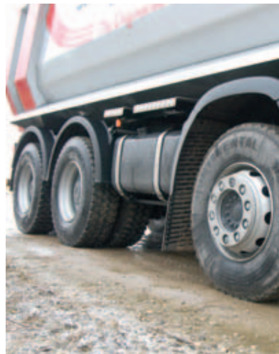
Eingeschränkte Bodenfreiheit durch Auspuffanlage und Tank.
