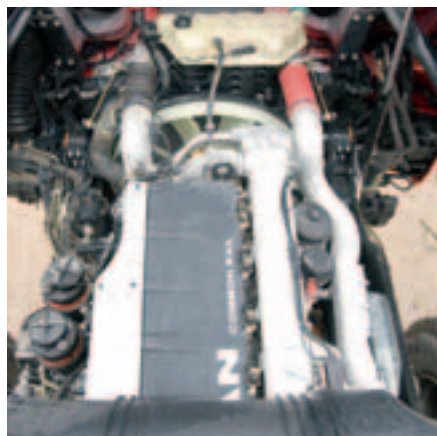
Neue 480-PS-Kraft bei MAN – Sechszylinder D26 mit Common-Rail-Einspritzung und Abgasrückführung.
