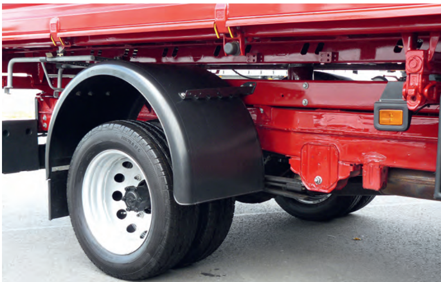
Die Hinterachse des schwersten TGE hat strammere Federn erhalten; rundum schaffen 17-Zoll-Räder Platz für größere Scheibenbremsen.
