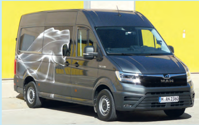
Der MAN-Löwe fletscht angriffslustig seine Zähne: 3,5-Tonner mit Hinterradtrieb. TGE6a 3,5 Tonnen und gerundet 180 PS, noch eine etwas raubeinige Kombination.
