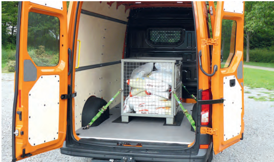
Niedriger Ladeboden, helles Licht, kräftige Zurrösen, genügend Nutzlast – aber rechtzeitig auf die eingeschränkte Länge achten.
