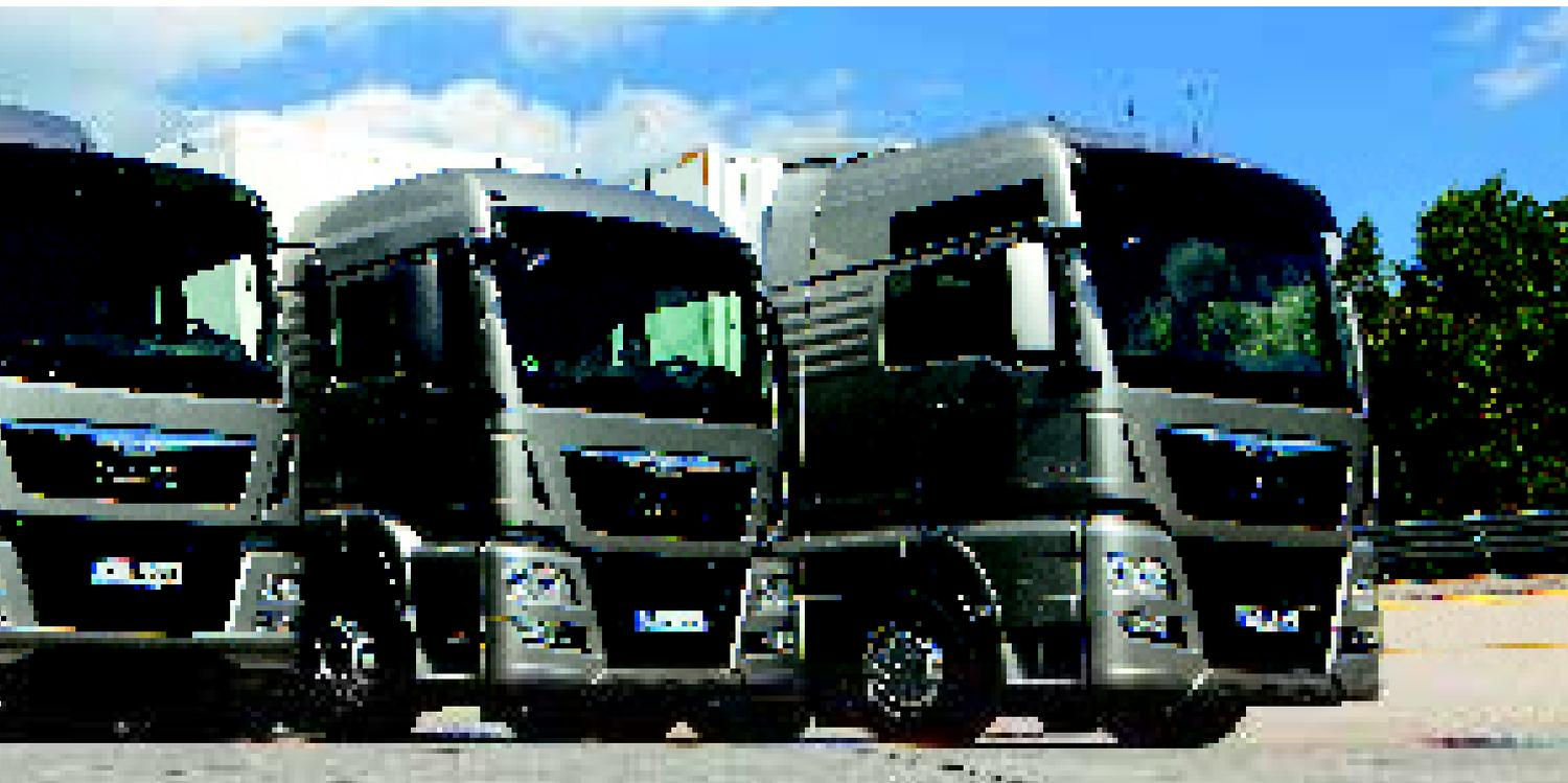
der zweiachsigen TGX-Sattelzugmaschine mit XLX-Kabine, sind auch TGS- und TGX-Modelle mit drei Achsen, größeren oder kleineren Fahrerhäusern und verschiedenen Federungsvarianten mit Efficient-Line-Paketen erhältlich. Hinzu kommt eine serienmäßige Ausstattung
